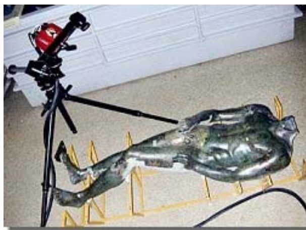
Fig. 3 Trodimenzionalna digitalizacija Apoksiomena pomoću sustava ATOS II firme GOM mbH.
