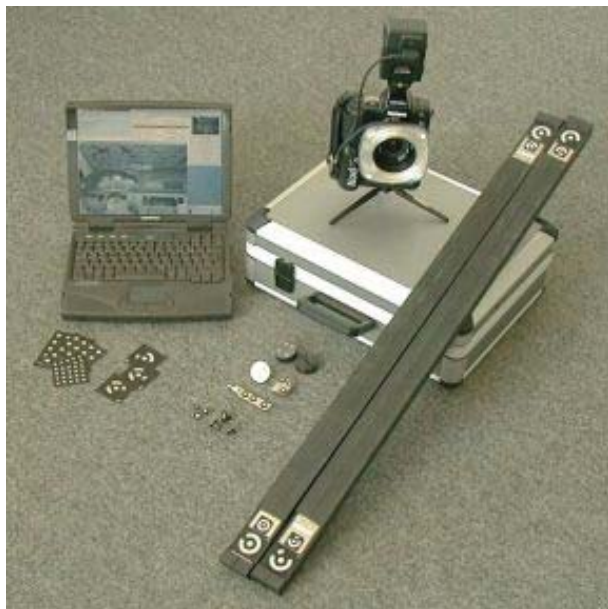
Slika 2. Fotogrametrijski sustav TRITOP firme GOM mbH.
