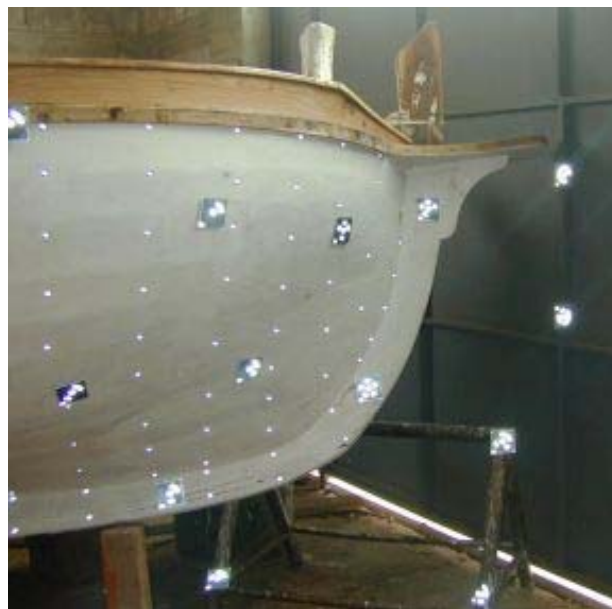
Slika 3. Pramac gajete pripremljene za fotogrametrijsko snimanje.
