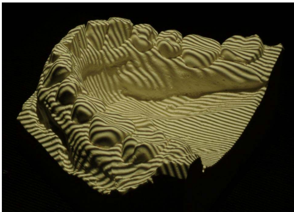
Slika 7. Projekcija linija na odljevak donjeg zubala prilikom 3D-digitalizacije pomoću sustava ATOS.
