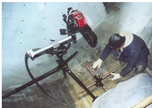
Slika 4. 3D-digitalizator "Atos" - kalibracija
