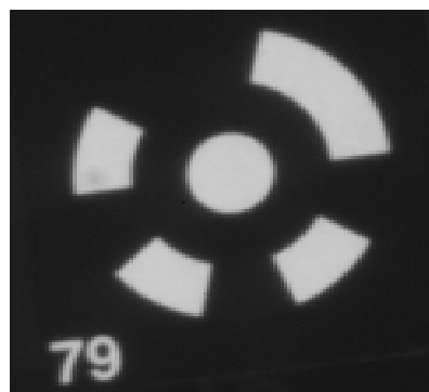
Slika 2. Kodirana referentna točka
